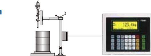
Fass-, Kanister- oder Palettenwaage
