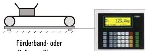
Förderband- oder Rollgang-Waage
